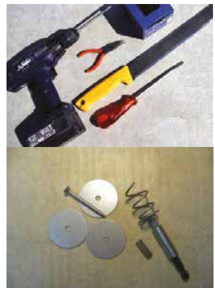
FireSAFE PR30 levyn kiinnitys puuruuveilla ja aluslevyillä kattoristikoon. Levyjen asennus on helppoa ja sujuvaa ruuviväännintä käyttämällä.
